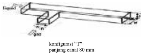
Gambar 2. Dua konfigurasi canal (konfigurasi T dan konfigurasi serpent) yang digunakan dalam eksperimen
