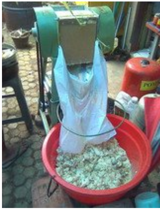
Gambar 2.3. Proses Penghancuran Singkong dan Pemasakan bahan baku
